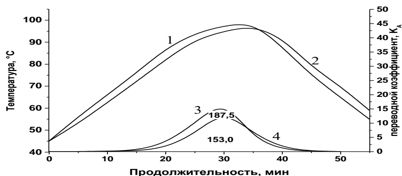
Рисунок 1 – Графики нагрева (1,2) и гибели микроорганизмов (3,4) в периферийной (1,3) и центральной (2,4) точках банки объемом 0,5 литров при стерилизации компота абрикосового в автоклавах по традиционному режиму
