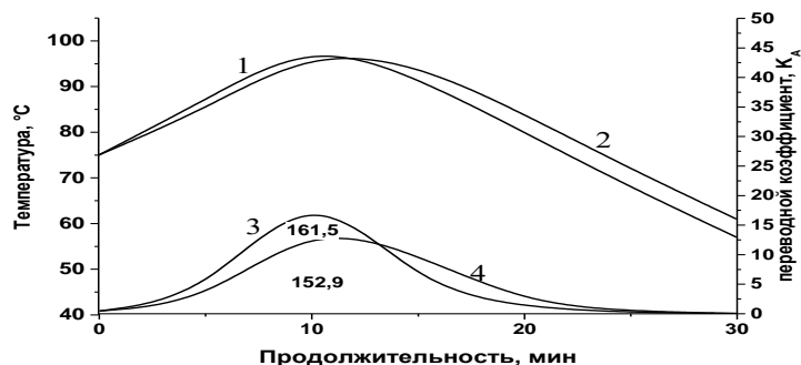
Рисунок 2 – Кривые нагрева (1,2) и гибели микроорганизмов (3,4) в периферийной (1,3) и центральной (2,4) точках банки объемом 0,5 литров при стерилизации компота абрикосового с предварительным СВЧ-нагревом полуфабриката в стеклбанках и стерилизации в аппаратах открытого типа
