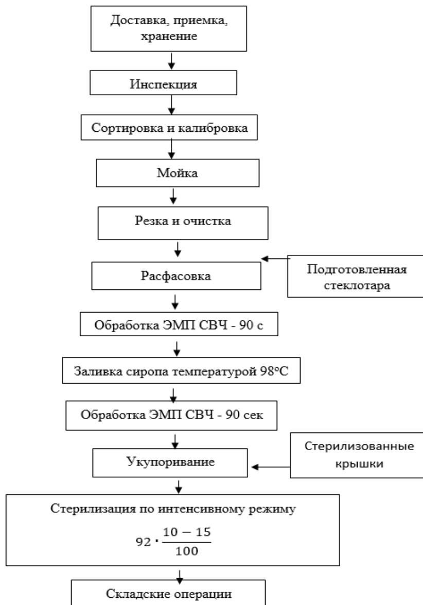
Рисунок 2– Структурная схема усовершенствованной технологии яблочного компота с использованием двухэтапной СВЧ-обработки и ускоренных режимов стерилизации
