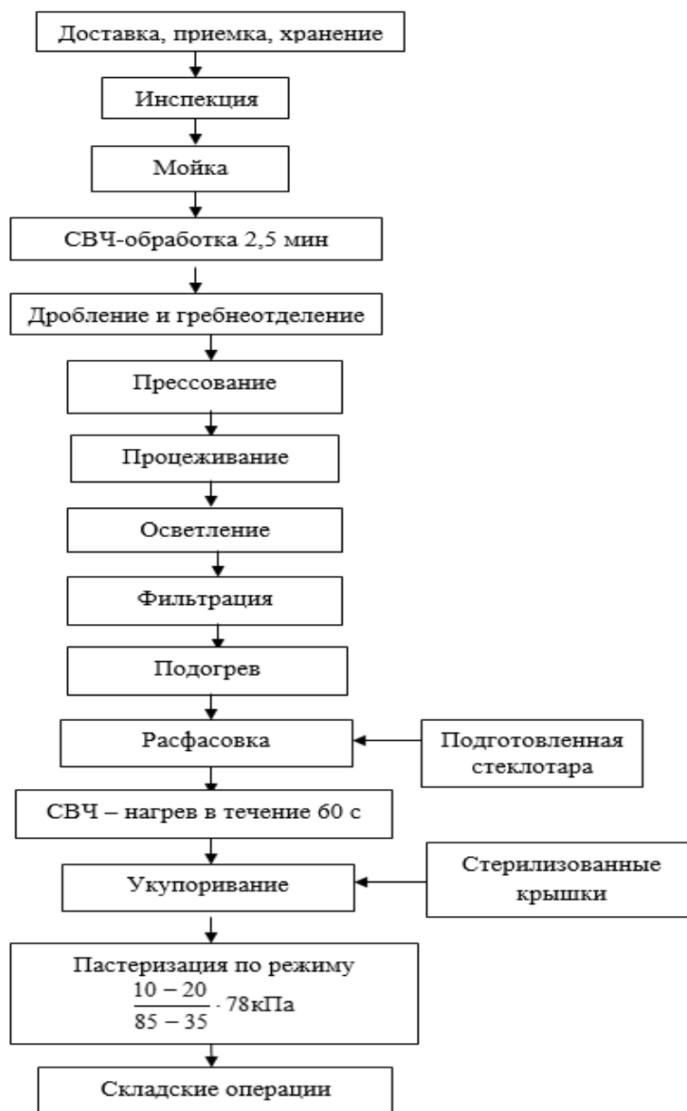
Рисунок 3 – Инновационная технологическая схема производства консервов «Сок виноградный» с использованием ЭМП СВЧ и ускоренного режима пастеризации
