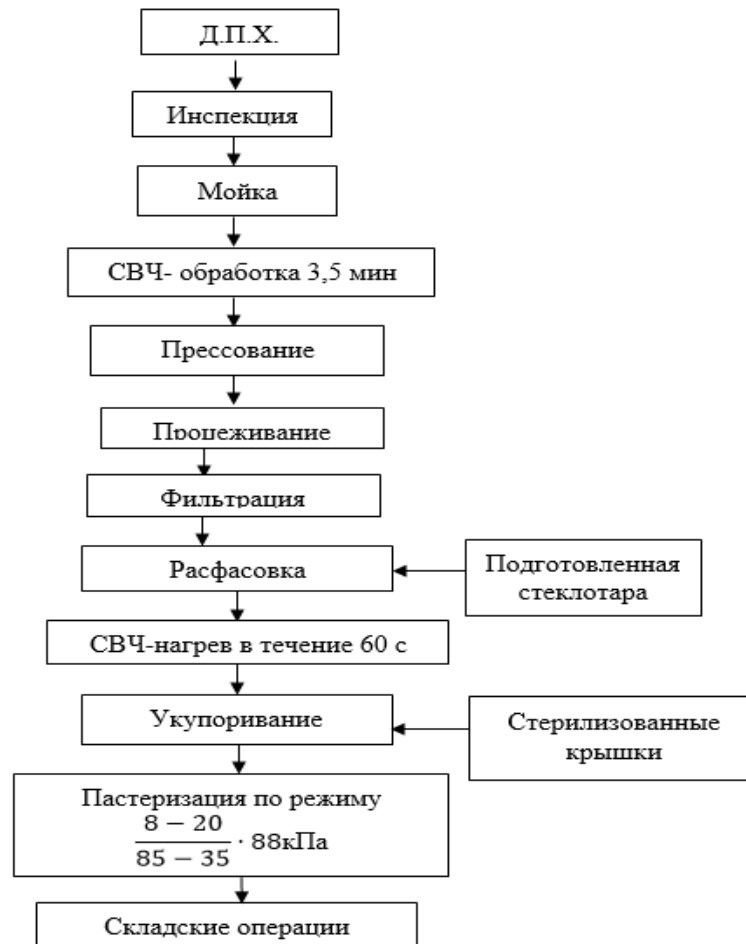
Рисунок 3– Инновационная технологическая схема производства яблочного сока для детского питания с использованием ЭМП СВЧ на этапах перед прессованием и герметизацией банок и ускоренного режима пастеризации
