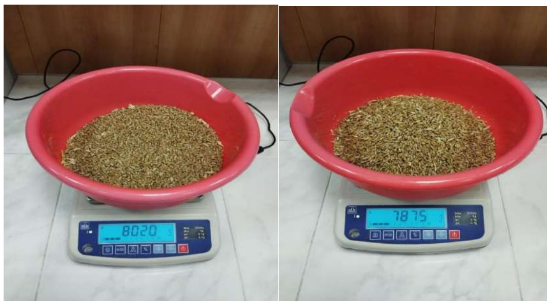
Рисунок 8 – Значение массы зерна при определении натуры зерна пшеницы
