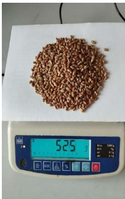
Рисунок 6 - Результаты измерения массы 1000 зёрен двух сортов пшеницы: «Силач элита» (слева) и «Челяба 75» (справа)
